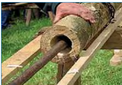
Herstellung einer Holzrohrwasserleitung
